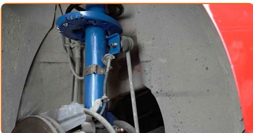
**65** Zategnite pritrdilni element, ki povezuje jarmov drog na blažilnik. Uporabite nasadni ključ №17. Uporabite navorni ključ. Zategnite ga do navora 40 Nm.
