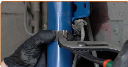
**64** Namestite prečno povezavo stabilizatorja.
