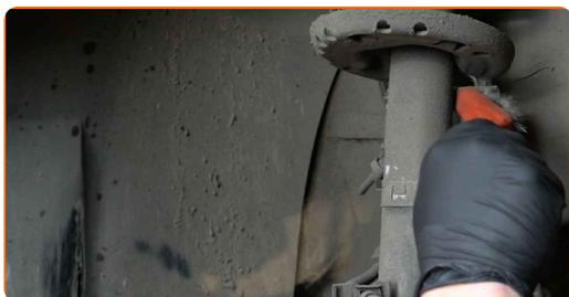
**14** Odvijte pritrdilni element, ki povezuje jarmov drog na blažilnik. Uporabite nasadni ključ №17. Uporabite izvijač z zatikalom.
