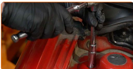
**5** Odstranite zaščitni pokrovček z nosilca opornika amortizerja.
