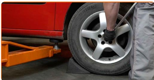
**8** Vzdignite sprednji del avtomobila in otdrite podpornike.
