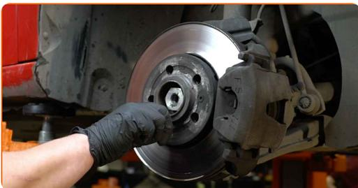
**12** Uporabite nasadni ključ №36. Uporabite udarni nasadni ključ.
