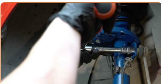
**66** Obdelajte pritrdilne elemente blažilnika. Obdelajte vse dele prečnega vodila. Uporabite bakreno mast.
