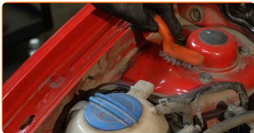
**4** Sprostite zgornji pritrdilni element sedeža za namestitev blažilnika. Uporabite nasadni ključ №13. Uporabite izvijač z zatikalom.
