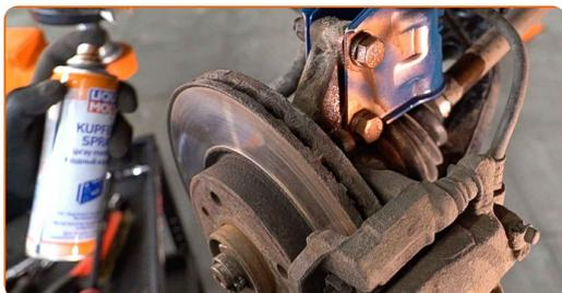
46 Očistite nosilec platišča kolesa. Uporabite žično krtačo. Obdelajte kontaktno površino. Uporabite bakreno mast.
