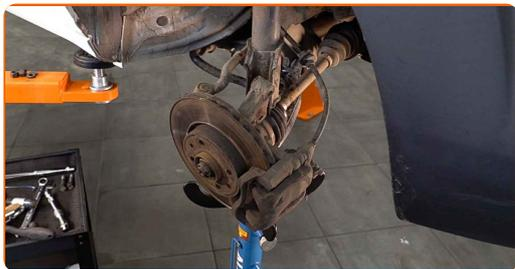
16 Odvijte pritrdilne elemente na vrhu nosilca amortizerja.
