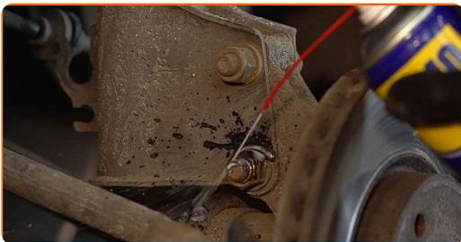
**12** Odvijte spodnji pritrdilni element, ki povezuje blažilnik s premnikom. Uporabite kombinirani ključ №19. Uporabite nasadni ključ №19. Uporabite udarni nasadni ključ.
