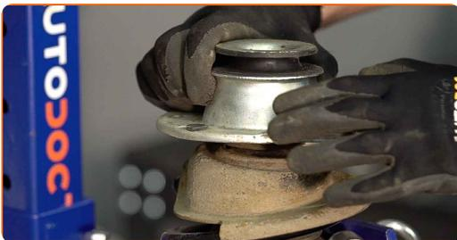
33 Zategnite matico amortizerja. Uporabite nasadni ključ №19. Uporabite imbus št. H6. Uporabite navorni ključ. Zategnite ga do navora 65 Nm.
