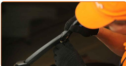
**4** Odstranite metlico iz ročice brisalnika. Uporabite ploščat izvijač.
