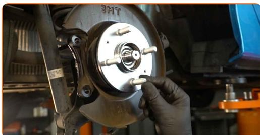
**24** Zategnite pesto. Uporabite nasadni ključ №32. Uporabite navorni ključ. Zategnite ga do navora 181 Nm.
