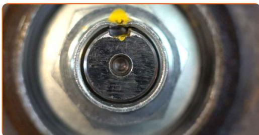
**20** Odvijte vijak osi pesta kolesa. Uporabite nasadni ključ №32. Uporabite udarni nasadni ključ.
