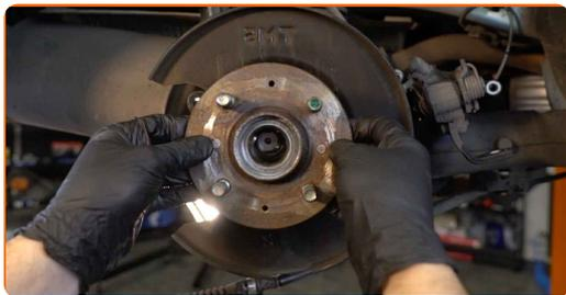
**22** Očistite nosilec ležaja pesta. Uporabite večnamenski čistilni sprej.
