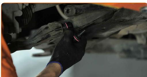
12 Namestite pritrditev palice na stabilizator in ga zategnite. Uporabite kombinirani ključ №14. Uporabite imbus št. H6. Uporabite navorni ključ. Zategnjite ga do navora 39 Nm.
