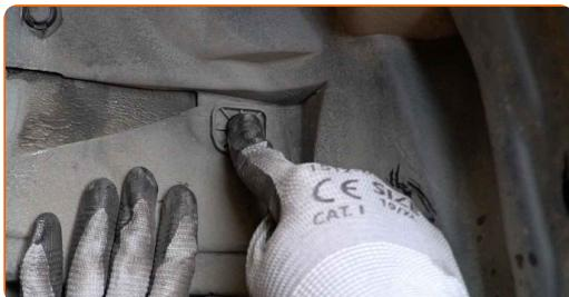
**18** Zategnite pritrdilne elemente na spodnjem pokrovu oljnega korita. Uporabite Phillips križni izvijač.
