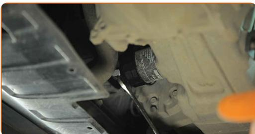
10 Odložite stari oljni filter v posodo.
