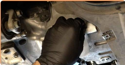
7 Privijte nov drenažni čep in ga zategnite. Uporabite nasadni ključ №17. Uporabite navorni ključ. Zategnite ga do navora 39 Nm.
