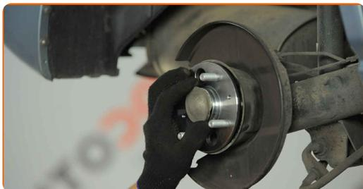
**27** Obdelajte pesto, kjer je v stiku z zavornim kolutom. Uporabite bakreno mast.
