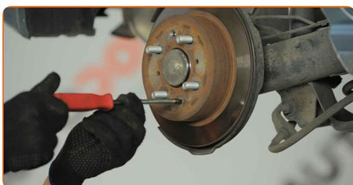
**30** Očistite umazanijo in prah iz nosilca zavorne čeljusti. Uporabite žično krtačo. Uporabite čistilo zavor.
