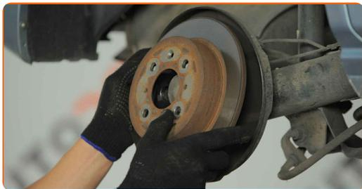
**29** Zategnite pritrditve zavornega diska. Uporabite Phillips križni izvijač. Uporabite navorni ključ. Zategnite ga do navora 10 Nm.
