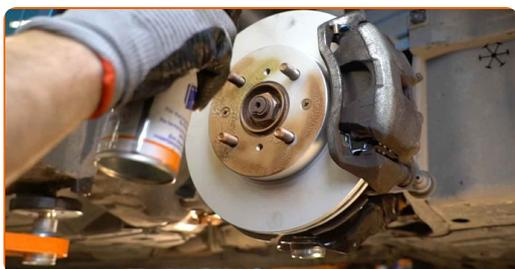
**37** Očistite površino zavornih kolutov. Uporabite čistilo zavor.
