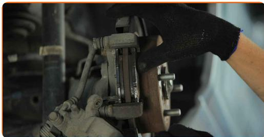
**35** Namestite zavorno čeljust in jo privijte. Uporabite nasadni ključ N°12. Uporabite navorni ključ. Zategnite ga do navora 23 Nm.
