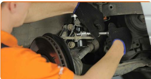
**13** Odstranite nosilec z opornika amortizerja.
