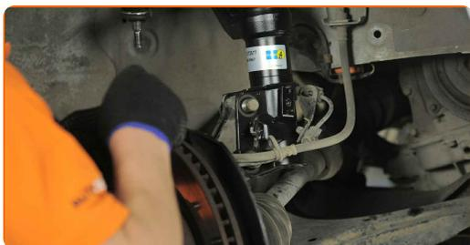
**45** Pritrdite spodnje pritrdilne elemente, ki povezujejo blažilnik in premnik. Uporabite kombinirani ključ №19. Uporabite nasadni ključ №22. Uporabite navorni ključ. Zategnite ga do navora 157 Nm.
