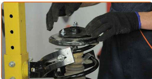
**32** Zategnite matico amortizerja. Uporabite kombinirani ključ №19. Uporabite imbus št. H7. Uporabite navorni ključ. Zategnite ga do navora 44 Nm.
