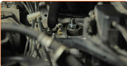
22 Odvijte pritrdilne elemente na vrhu nosilca amortizerja. Uporabite nasadni ključ №14. Uporabite izvijač z zatikalom.
