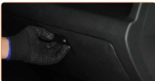
**3** Odstranite zamašek (trak) iz pokrova predala za rokavice. Uporabite ploščat izvijač.
