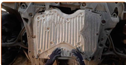
**19** Privijte pritrdilne elemente spodnje zvočne izolacije. Uporabite nasadni ključ №10. Uporabite izvijač z zatikalom.
