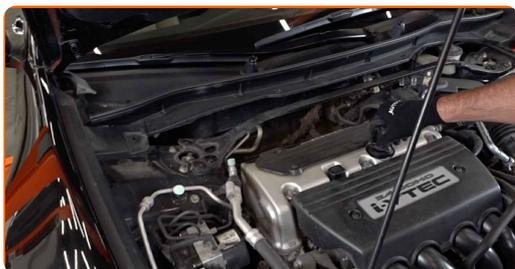
25 Pustite da motor nekaj minut deluje. Ko ugasne opozorilna lučka za pritisk olja, ugasnite motor.
