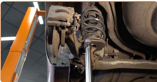
**9** Odvijte spodnjo pritrditev amortizerja. Uporabite nasadni ključ N°E20. Uporabite izvijač z zatikalom.
