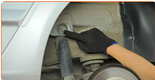
**7** Sprostite spodnji pritrdilni element blažilnika. Uporabite nasadni ključ N°E20. Uporabite izvijač z zatikalom.
