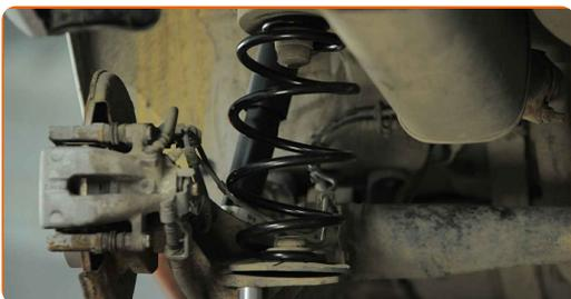
**18** Podprite zadnji nosilec vzmetenja. Uporabite dvigalko s hidravličnim prenosom.
