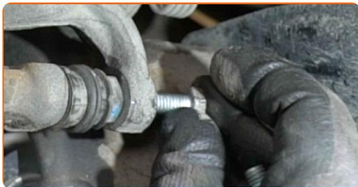
**19** Zategnite pritrdilne elemente zavorne čeljusti. Uporabite nasadni ključ №13. Uporabite navorni ključ. Zategnite ga do navora 35 Nm.
