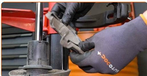
**39** Odstranite stari amortizer s kompresorja hidravlične spiralne vzmeti.
