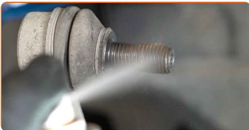
**62** Namestite prečno povezavo stabilizatorja.
