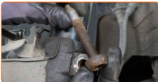
**26** Sprostite spodnji pritrdilni element, ki povezuje blažilnik s premnikom. uporabite poseben nastavek za nasadni ključ za odstranitev blažilnika.
