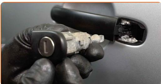
**35** Privijte pritrdilni element cilindra ključavnice vrat. Uporabite vijačni nastavek T20.
