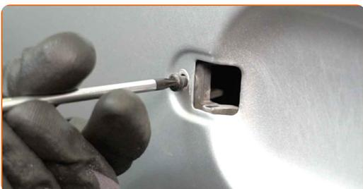
**8** Odvijte pritrdilne elemente zunanjega panela vrat. Uporabite vijačni nastavek T30. Uporabite izvijač z zatikalom.
