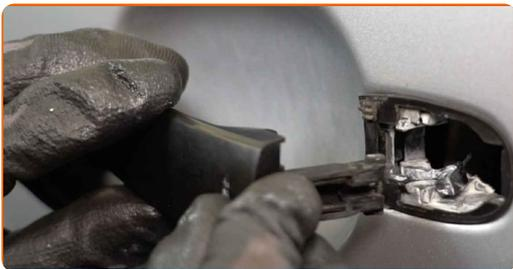
**33** Namestite kabel kljuke za zaklepanje. Uporabite ploščat izvijač.
