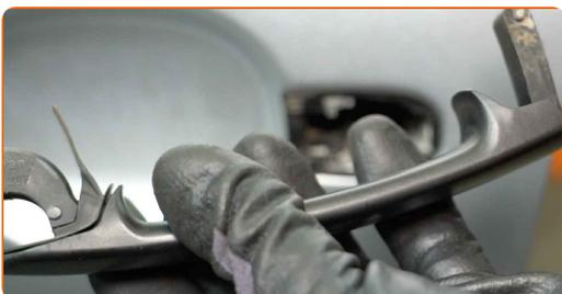
**7** Odvijte nosilec kljuko vrat. Uporabite vijačni nastavek T20.
