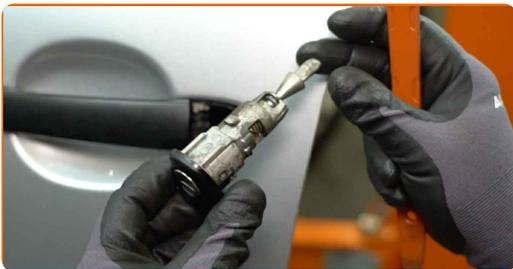
**5** Odstranite kabel kljuko za zaklepanje. Uporabite ploščat izvijač.
