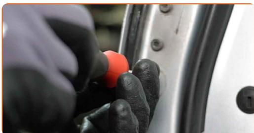
**4** Odstranite cilindar ključavnice vrat. Uporabite plastično orodje za demontažo.
