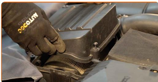
5 Odvijte pritrdilne elemente kartuše zračnega filtra. Uporabite Phillips križni izvijač.
