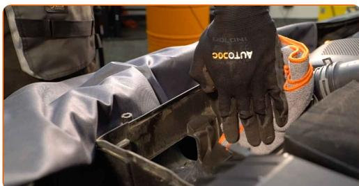
8 Očistite pokrov zračnega filtra in ohišje.
