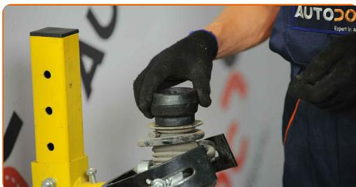
**27** Zategnite matico amortizerja. Uporabite nasadni ključ №20. Uporabite navorni ključ. Zategnite ga do navora 60 Nm.
