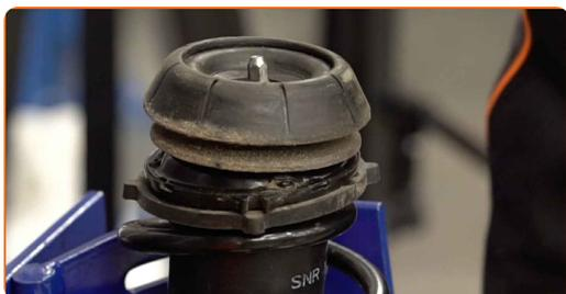
26 Zategnite matico amortizerja. Uporabite kombinirani ključ №19. Uporabite nasadni ključ №9. Uporabite navorni ključ. Zategnite ga do navora 50 Nm.
