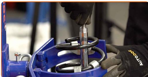
28 Namestite nosilec, protiprašno zaščito in blažilec na nov amortizer.
