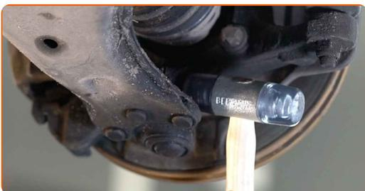
**9** Odvijte pritrditev sprednje roke. Uporabite nasadni ključ №18. Uporabite kombinirani ključ №18. Uporabite izvijač z zatikalom.
