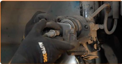
16 Očistite umazanijo in prah iz nosilca zavorne čeljusti. Uporabite žično krtačo. Uporabite čistilo zavor.
