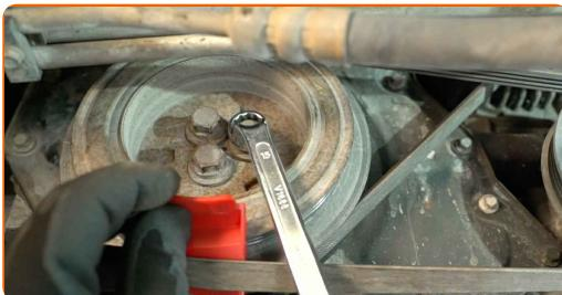
**3** Z vrtenjem jermenice ročične gredi odstranite rebrasti jermen alternatorja. Uporabite orodje za odstranjevanje/montažo napenjalnega jermenja. Uporabite montažni vzvod. Uporabite kombinirani ključ 15 mm.
