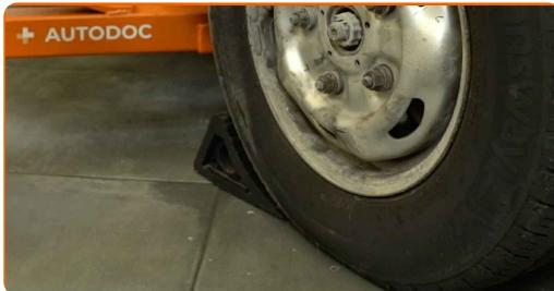
**4** Sprostite kolesne matice. Uporabite udarni nasadni ključ za kolesne matice 21 mm. Uporabite vrtljivi zatič.
