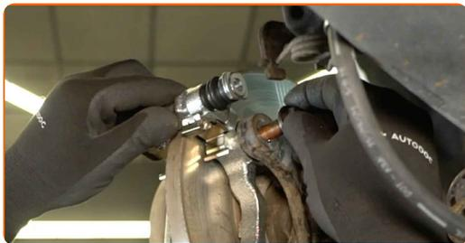
24 Zategnite pritrdilne elemente nosilca zavornega sedla. Uporabite natični nastavek 15 mm. Uporabite navorni ključ. Zatezni navor: 115 N-m.
