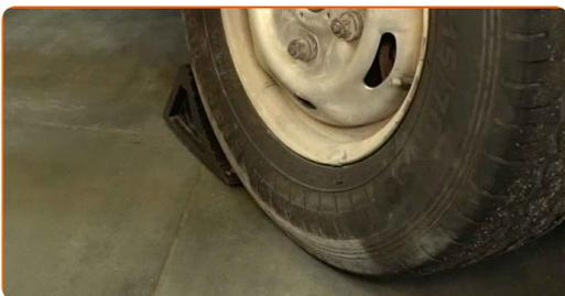
4 Sprostite matice koles. Uporabite udarni nasadni ključ za kolesne matice 21 mm. Uporabite vrtljivi zatič.
