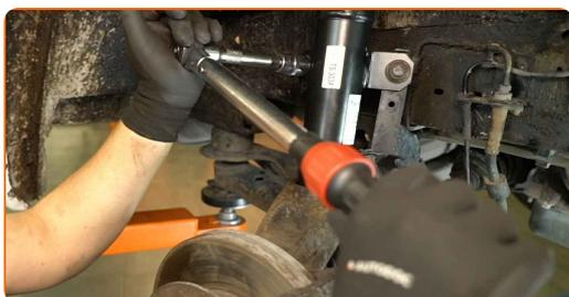
**79** Zategnite pritrdilni element nosilca kabla senzorja ABS. Uporabite natični nastavek 18 mm. Uporabite navorni ključ. Zatezni navor: 45 Nm.
