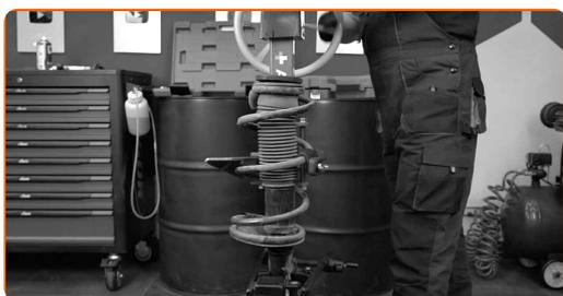
**55** Odstranite ležaj nosilca in odbojnik.
