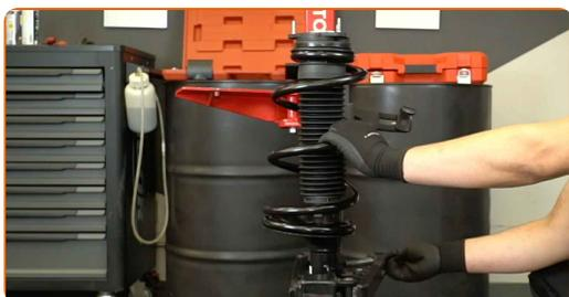
**66** S kompresorja vzmeti odstranite sklop vzmetne noge.
