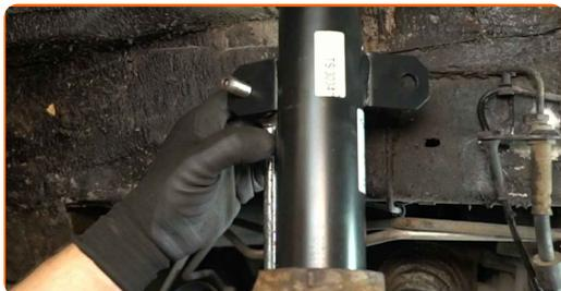
**77** Namestite nosilec kabla senzorja ABS in privijte pritrdilno matico.
