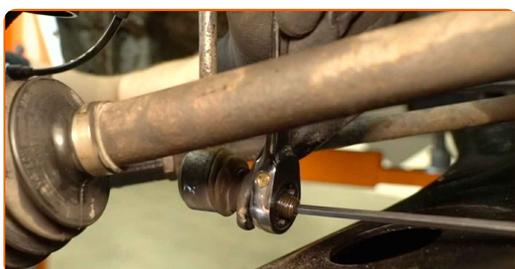
**8** Odvijte pritrdilni element, ki povezuje drog stabilizatorja z vzmetno nogo. Uporabite natični nastavek 19 mm. Uporabite ključ z ragljo.
