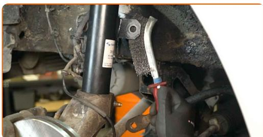
**12** Namestite novi drog stabilizatorja in njegove pritrdilne elemente.
