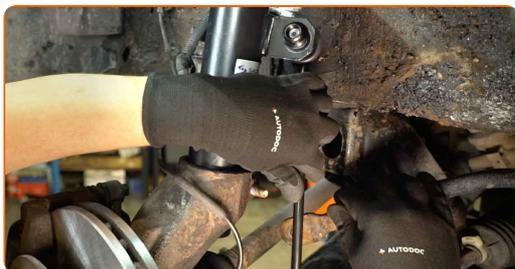
**13** Zategnite pritrdilni element, ki povezuje drog stabilizatorja s stabilizatorjem. Uporabite kombinirani ključ 20 mm. Uporabite natični nastavek 17 mm. Uporabite navorni ključ. Zatezni navor: 55 Nm.
