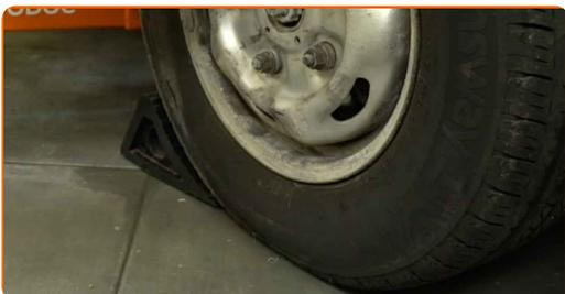
2 Sprostite kolesne matice. Uporabite udarni nasadni ključ za kolesne matice 21 mm. Uporabite vrtljivi zatič.
