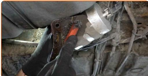
7 Odvijte nosilec filtra za gorivo. Uporabite nasadni ključ №8. Uporabite izvijač z zatikalom.
