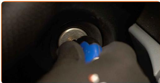
**32** Odklopite konektor s stikala električnega okna.
