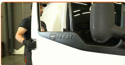
**2** Odvijte pritrdilne elemente vratnega panela. Uporabite izvijač Phillips.
