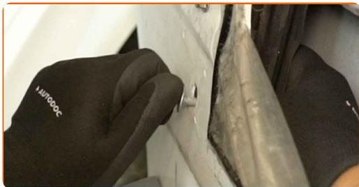
**17** Odvijte pritrdilne elemente mehanizma regulatorja okna. Uporabite natični nastavek 10 mm. Uporabite ključ z ragljo.
