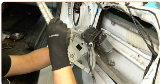
**20** Namestite nov mehanizem regulatorja okna.
