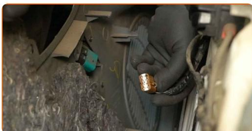
**7** Odvijte pritrdilne elemente zvočnika. Uporabite izvijač Phillips.
