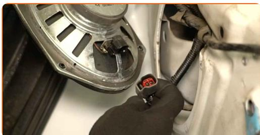
**11** Odklopite konektor z motorja električnega okna.
