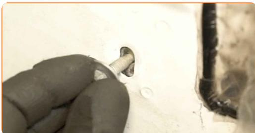
**25** Zategnite pritrdilni element vodilne tirnice okna. Uporabite natični nastavek 8 mm. Uporabite navorni ključ. Zatezni navor: 6 N·m.
