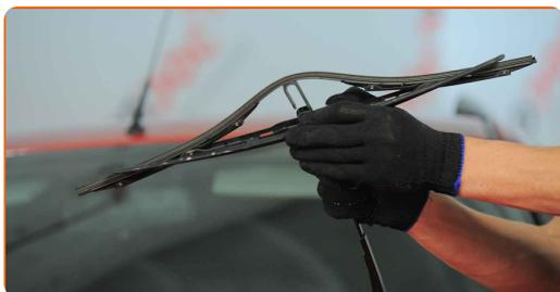
5 Odstranite metlico iz ročice brisalnika.
