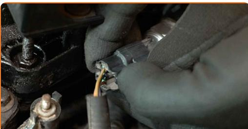
**18** Odklopite priključek senzorja tlaka sesalnega kolektorja.
