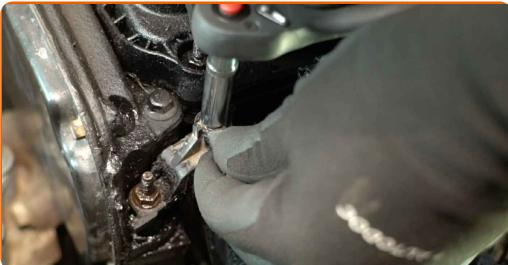
**17** Odklopite priključek senzorja tlaka goriva.
