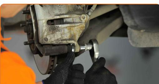
**12** Odstranite vodilne zatiče iz zavorne čeljusti.
