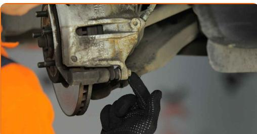
**11** Odvijte pritrditve zavorne čeljusti. Uporabite kombinirani ključ №19. Uporabite nasadni ključ №13. Uporabite izvijač z zatikalom.
