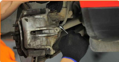
**10** Očistite pritrdilne elemente zavornih čeljusti. Uporabite žično krtačo. Uporabite sprej WD-40.
