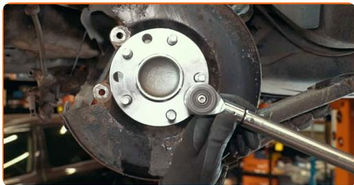
**28** Obdelajte pritrdilne elemente pesta. Uporabite bakreno mast.
