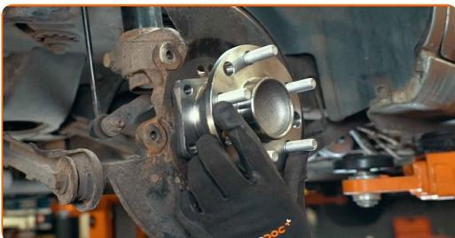
**27** Zategnite vijake pesta. Uporabite vijačni nastavek T50. Uporabite navorni ključ. Zategnite ga do navora 70 Nm.
