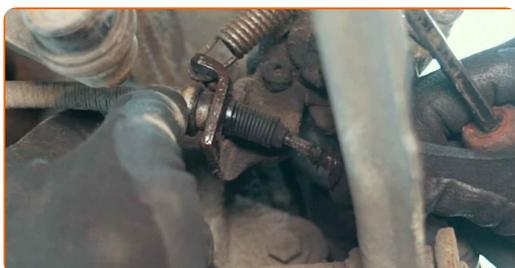
8 Očistite pritrdilne elemente zavornih čeljusti. Uporabite žično krtačo. Uporabite večnamenski čistilni sprej.
