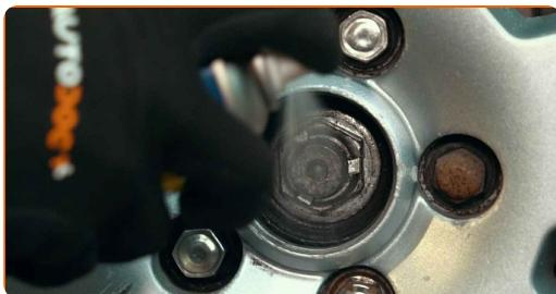
6 Sprostite pritrdilni element pogonske gredi. Uporabite nasadni ključ №32. Uporabite udarni nasadni ključ.
