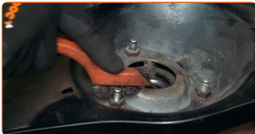
4 Sprostite zgornje pritrdilne elemente vzmetne noge (trije kosi). Uporabite nasadni ključ №13. Uporabite izvijač z zatikalom.
