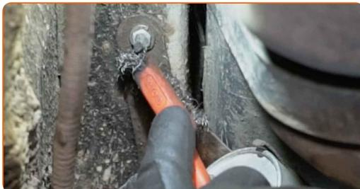
5 Odvijte pritrdilne vijke nosilca filtra za gorivo. Uporabite nasadni ključ №10. Uporabite izvijač z zatikalom.
