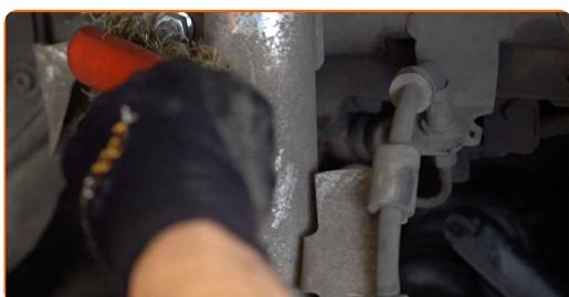
**19** Odvijte matico in odstranite drog stabilizatorja z opornika. Uporabite nasadni ključ №15. Uporabite izvijač z zatikalom.
