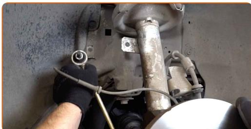
**20** Odvijte spodnji pritrdilni element, ki povezuje blažilnik s premnikom. Uporabite nasadni ključ №18. Uporabite izvijač z zatikalom. Uporabite udarni nasadni ključ.
