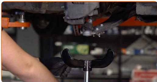
22 Sprostite spodnji pritrdilni element, ki povezuje blažilnik s premnikom. uporabite poseben nastavek za nasadni ključ za odstranitev blažilnika. Uporabite kladivo. Uporabite ravno dleto za kovino.
