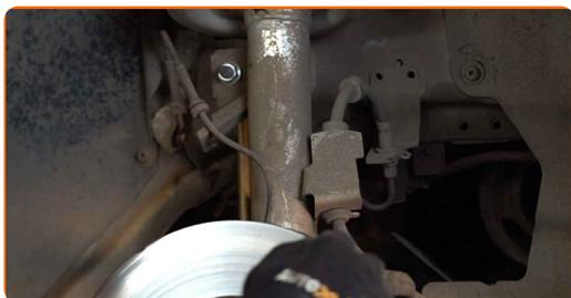
**18** Očistite pritrdilne elemente, ki povezujejo vezni element amortizerja na opornik amortizerja, in tiste, ki povezujejo opornik amortizerja s krmilnim členkom. Uporabite žično krtačo. Uporabite sprej WD-40.
