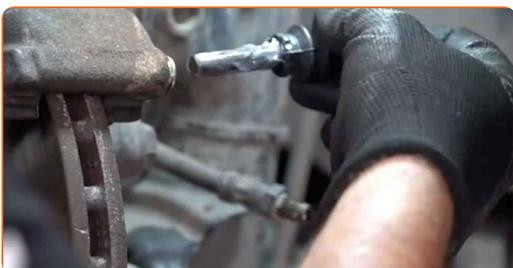
**23** Zategnite pritrdilne elemente zavorne čeljusti. Uporabite imbus št. H7. Uporabite navorni ključ. Zategnite ga do navora 35 Nm.
