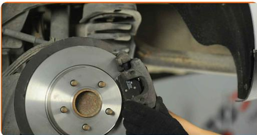
**20** Očistite vodilne zatiče okvirja kolutne zavore.
