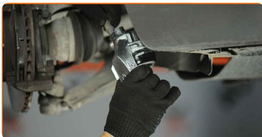
**26** Očistite vodilne zatiče okvirja kolutne zavore.
