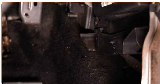
**4** Odvijte pritrdilne elemente ohišja filtra za notranji zrak. Uporabite vijačni nastavek T20. Uporabite izvijač z zatikalom.
