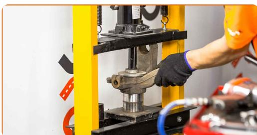
**29** Pritisnite pesto kolesa v notranji ležaj.. Uporabite komplet puše in ležaja gonilnika.
