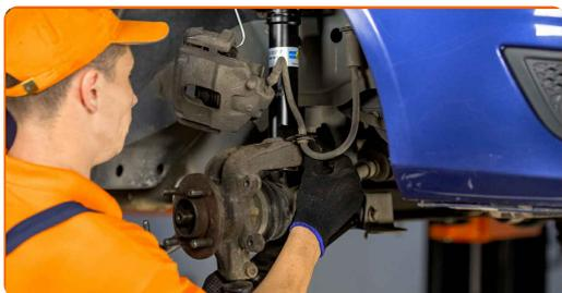
**32** Popravite opornik amortizerja na členku volana.
