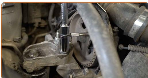
**61** Odvijte pritrdilne elemente vležajenja motorja. Uporabite nasadni ključ №16. Uporabite izvijač z zatikalom.
