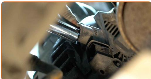
**18** Odstranite kabelsko napeljavo alternatorja.
