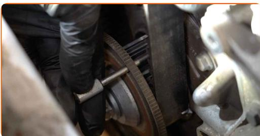
**89** Obrnite jermenico ročne gredi. Uporabite nasadni ključ №18. Uporabite izvijač z zatikalom.
