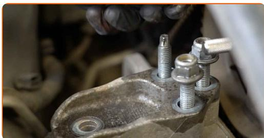
**63** Odstranite vležajenje motorja.
