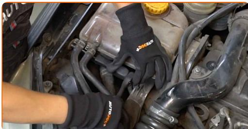
4 Sprostite držala rezervoarja hladilnega sredstva. Uporabite ploščat izvijač.
