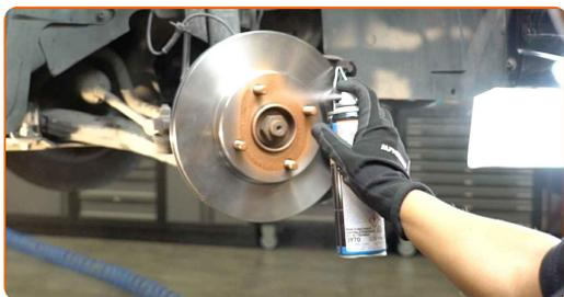
**28** Očistite površino zavornih kolutov. Uporabite čistilo zavor.
