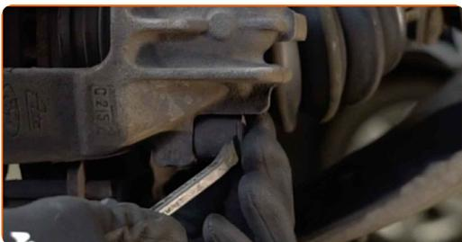
**8** Očistite pritrdilne elemente zavornih čeljusti. Uporabite čistilno krtačo iz najlona. Uporabite čistilo zavor.
