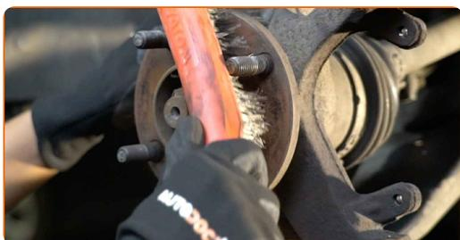
**17** Očistite umazanijo in prah iz nosilca zavorne čeljusti. Uporabite žično krtačo. Uporabite čistilo zavor.
