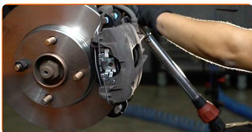
**26** Namestite pokrovčke manšete vodilnih zatičev zavornih čeljusti.
