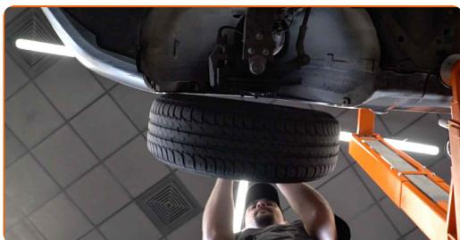
**17** Odklopite kable in zavorno cev iz nosilca za amortizer.
