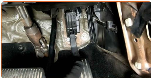
**15** Vrnite pedal za plin v prvoten položaj in privijte njegov pritrdilni element. Uporabite nasadni ključ №10. Uporabite izvijač z zatikalom.
