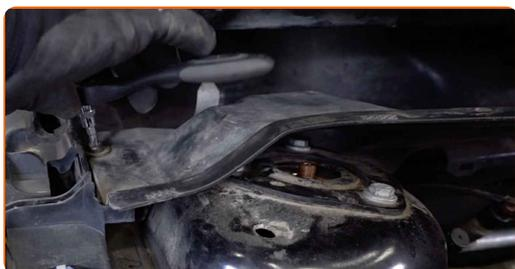
**54** Namestite pritrdilne elemente rešetke pod vetrobranskim steklom.
