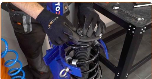
**36** Zategnite matico amortizerja. Uporabite vijačni nastavek T30. Uporabite kombinirani ključ №19. Uporabite navorni ključ. Zategnite ga do navora 50 Nm.
