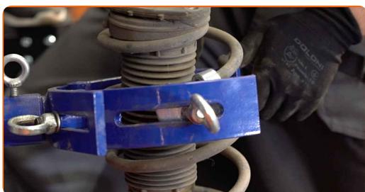
**29** Odstranite matico oporne batnice. Uporabite vijačni nastavek T40. Uporabite kombinirani ključ №19. Uporabite izvijač z zatikalom.
