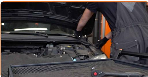
**4** Odvijte pritrdilni element metlic brisalcev vetrobranskega stekla. Uporabite nasadni ključ N°15. Uporabite izvijač z zatikalom.
