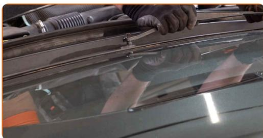
**56** Zategnite pritrdilne elemente metlic brisalcev. Uporabite nasadni ključ №15. Uporabite navorni ključ. Zategnite ga do navora 10 Nm.
