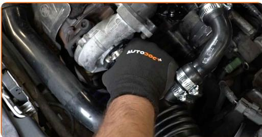
**11** Zategnite pritrdilne objemke, ki pritrjujejo zračno cev na ohišje zračnega filtra in na kompresor. Uporabite nasadni ključ №7. Uporabite izvijač z zatikalom.
