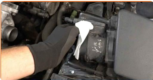
**9** Namestite cev za dovod zraka in jo pričvrstite.
