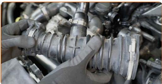
**8** Očistite vgradni prostor cevi za dovod zraka.
