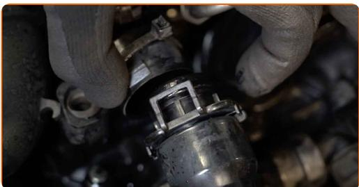
**7** Odstranite cev za dovod zraka.
