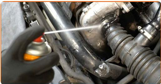
**5** Zrahljajte pritrdilne objemke, ki pritrjujejo zračno cev na ohišje zračnega filtra in na kompresor. Uporabite nasadni ključ №7. Uporabite izvijač z zatikalom.
