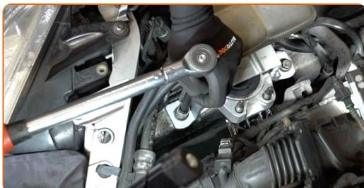
**16** Obdelajte pritrdilne elemente nosilca motorja. Uporabite bakreno mast.
