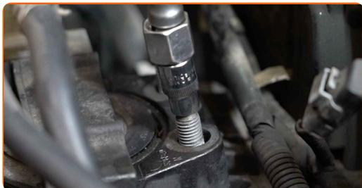
**11** Odstranite vležajenje motorja.
