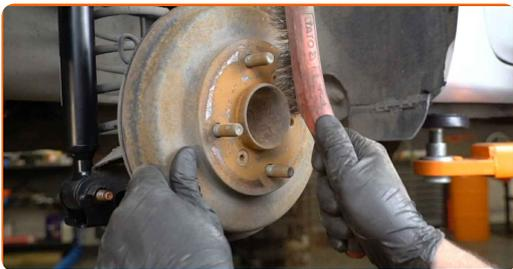
**37** Obdelajte površino, kjer se platišče kolesa dotika zavornega bobna. Uporabite bakreno mast.
