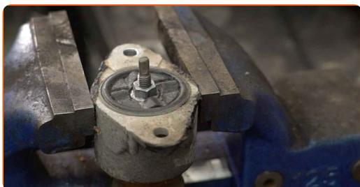
**17** Očistite pritrdilni element blažilnika v obliki palice. Uporabite žično krtačo. Uporabite sprej WD-40.
